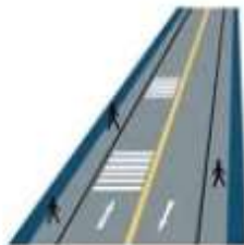
"เส้นชะลอความเร็ว" Rumble strips
