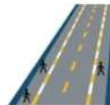
"เครื่องหมายเส้นห้ามจอด เว้นแต่หยุดรับ-ส่งชั่วคราว" Parking prohibited except temporary loading and unloading
